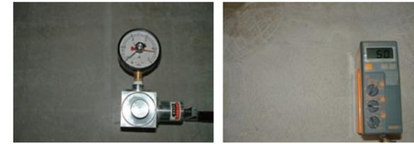
引張試験器で強度を測定
